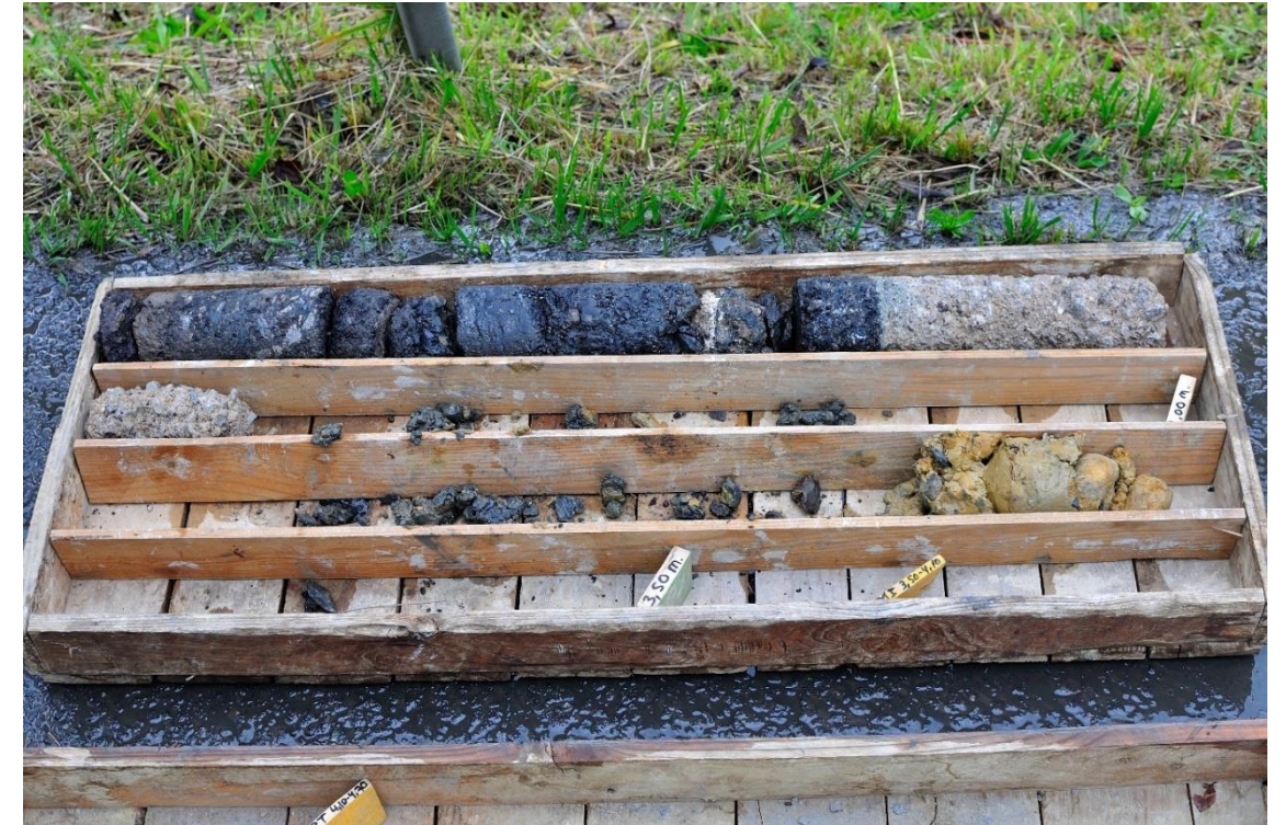
Vista de los primeros metros del sondeo SAU-1, en los que se aprecia la variedad de materiales antrópicos utilizados para la creación de la explanada de la carretera N-240.
