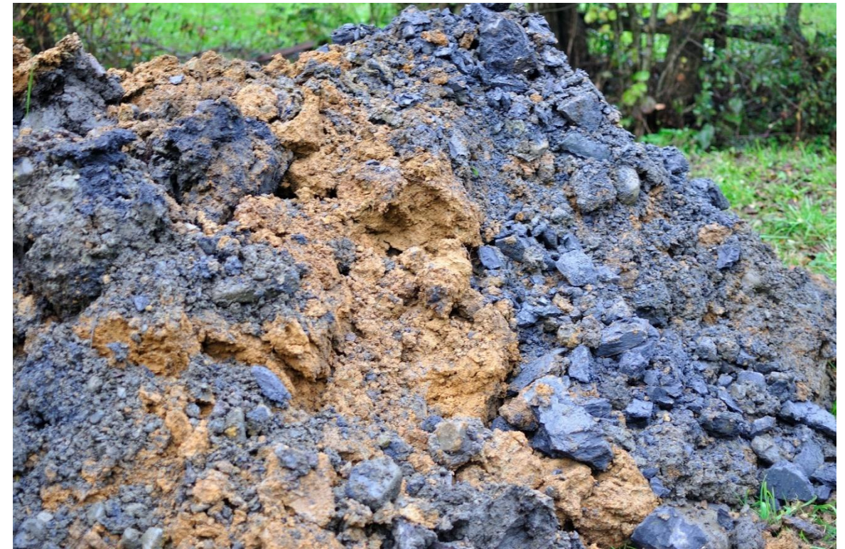
Vista del material lutítico más superficial (azul) puesto de manifiesto en la calicata CAU-4
